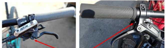
Molette ou vis de réglage de la garde du frein, se présentant de façon différente en fonction des modèles qui en sont pourvus.
