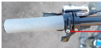
Vis de réglage de l'inclinaison du levier de frein sur le cintre.
